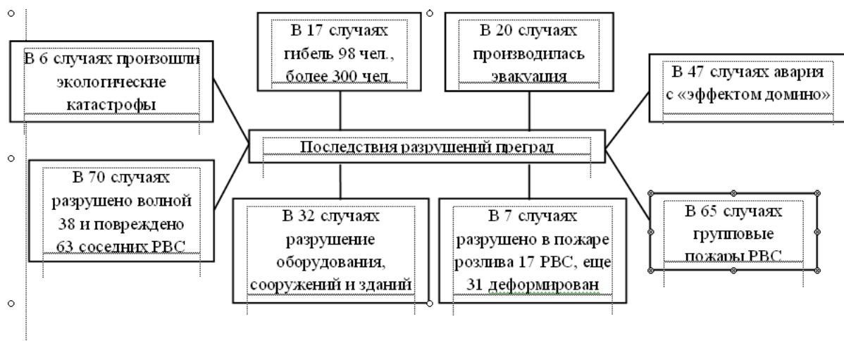
Рис. 6. Последствия разрушения преград при квазимгновенной разгерметизации резервуаров
